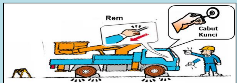
Saat ditinggalkan, harus mengaktifkan rem, mematikan power, mencabut kunci, & melepas safety belt.
